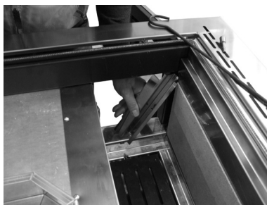
Fig. 66 - Retirer le profil
