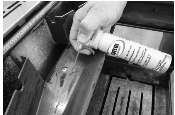
Fig. 62 - Liquide débloquant
