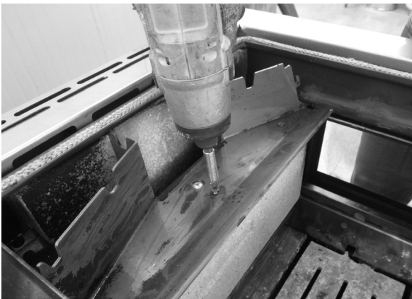
Fig. 63 - Retirer les vis
