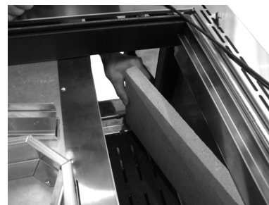
Fig. 67 - Retirer le matériau réfractaire
